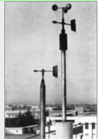
Figura 5 Anemografi installati sulla terrazza dell'Istituto di Fisica a Roma Fonte: Istituto Nazionale di Geofisica, supplemento alla rivista "Annali di Geofisica", Roma, 1949
